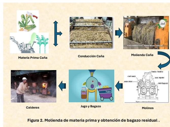
Figura 2. Molienda de materia prima y obtención de bagazo residual .
