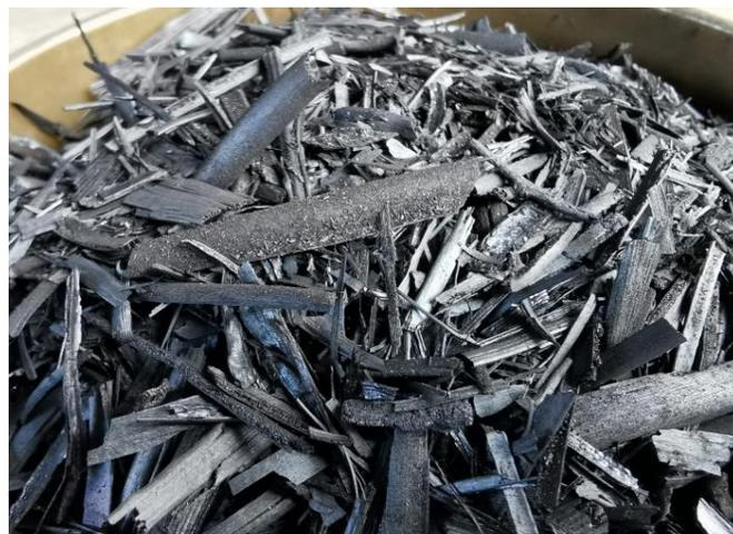
**Figura 3.** Biocarbón producido a partir de residuos de cosecha de caña de la azúcar, Estación Experimental DIECA, Grecia, Alajuela.
