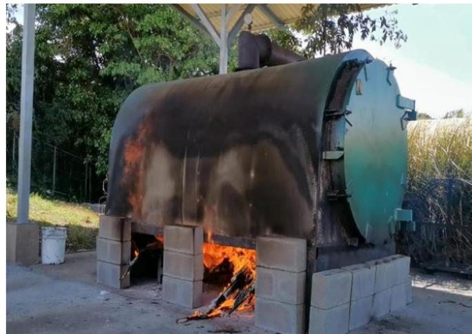
**Figura 2.** Proceso de pirólisis de residuos de cosecha de caña de azúcar, Estación Experimental DIECA, Grecia, Alajuela.
