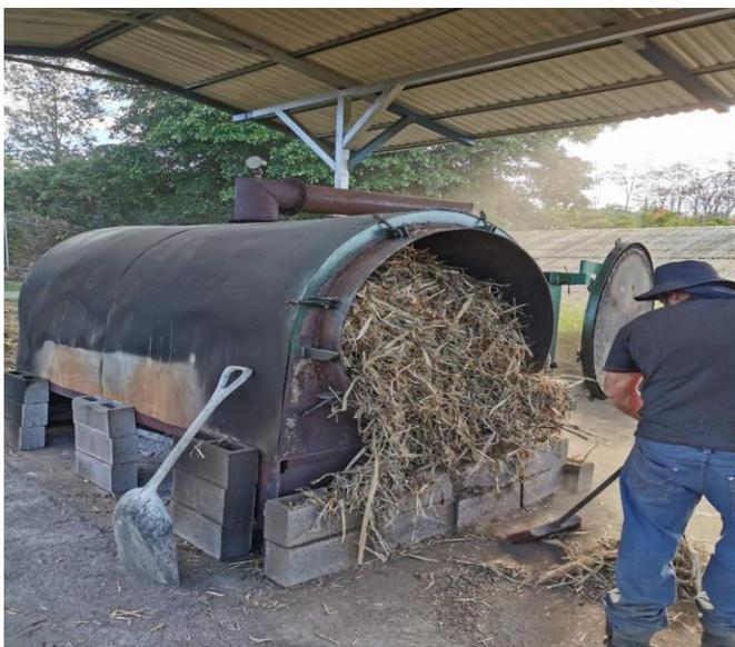
**Figura 1.** Llenado de horno de pirólisis con residuos de cosecha de caña de azúcar, Estación Experimental DIECA, Grecia, Alajuela.
